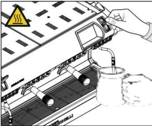
Откройте рычаг подачи пара. Прежде чем молоко достигнет желаемой температуры, установите трубку пара над поверхностью и небольшими вертикальными движениями касайтесь молока.
