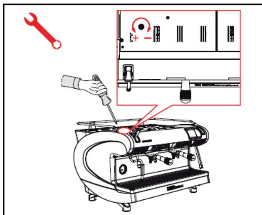
Используйте отвертку для регулирования винта на крышке кофемашины:
