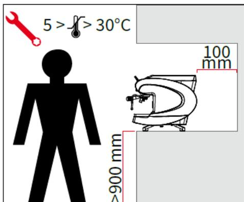
Перед установкой кофемашины на поверхность убедитесь, что размеры поверхности соответствуют размерам кофемашины, а поверхность может выдержать ее вес.
